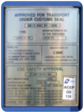
› CSC-plåt med märkning att containern ingår i ACEP-programmet
